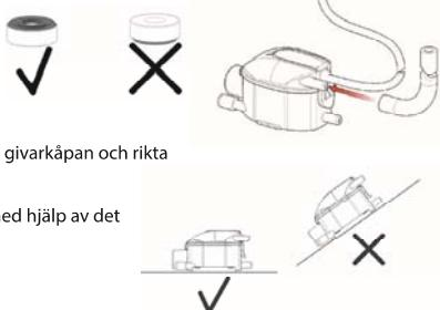
Anslut ventilationsröret på givarkåpan och rikta röret uppåt.
